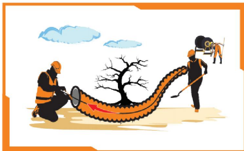
▲ Luồn cáp dễ dàng, có thể bố trí hố ga ở xa nhau hơn Allows easy cable pull in and permits longer distances between handholes
